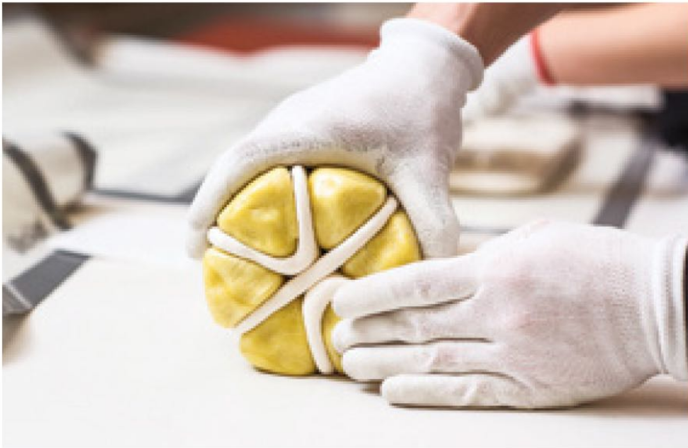
Die Zuckerln sollen wie eine aufgeschnittene Limette aussehen. Dafür werden die Massen entsprechend zusammengefügt.
